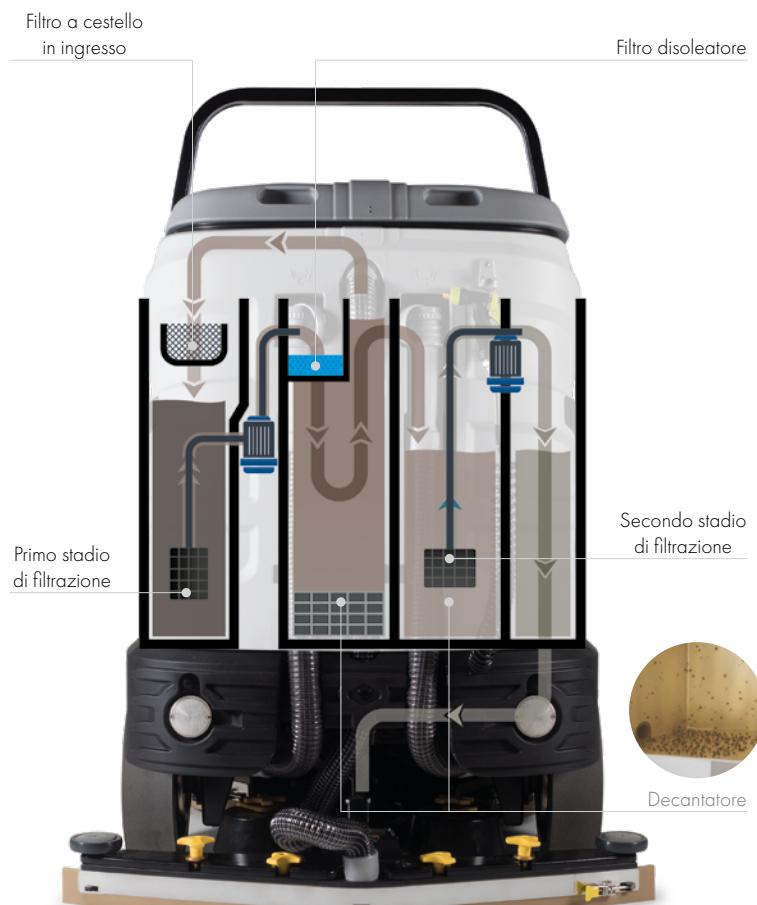
**1.** La soluzione utilizzata per la pulizia del pavimento viene raccolta nel serbatoio di recupero, dove passa per il filtro a cestello in modo da trattenere i residui solidi. Avviene qui anche il primo stadio di filtrazione.
