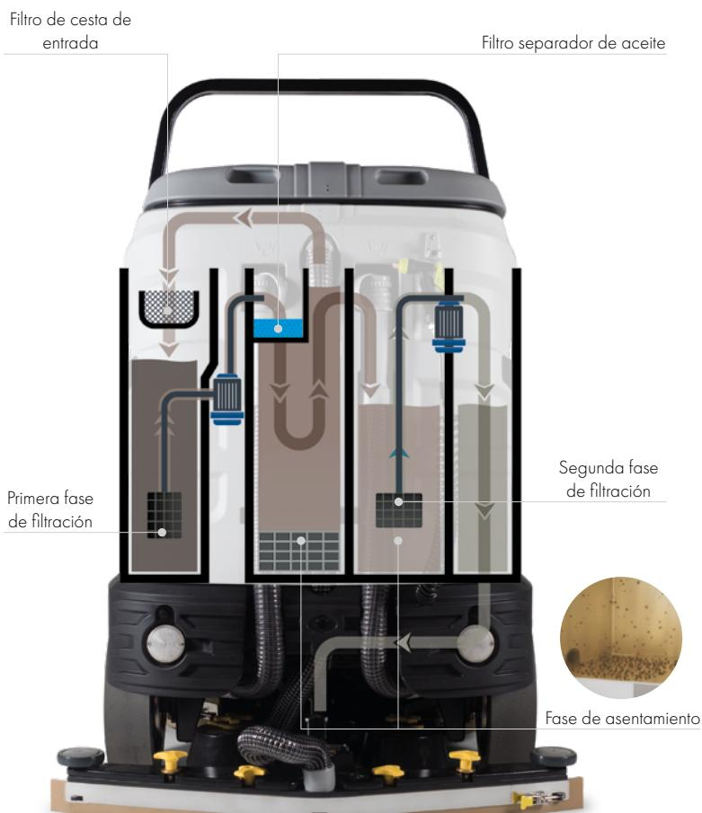
1. La solución utilizada para la limpieza del piso se recoge en el tanque de recuperación, donde pasa a través del filtro de cesta para retener los sólidos. Aquí también tiene lugar la primera fase de filtración.
